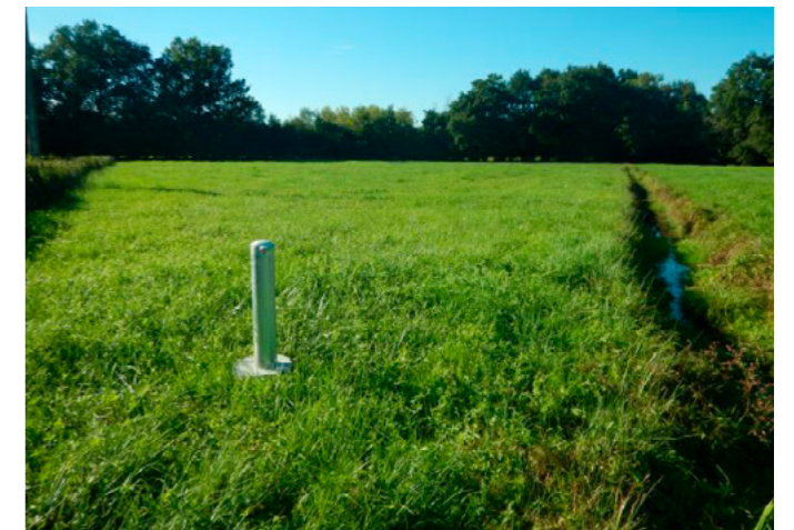
Figure 15b : Piézomètre en zone humide drainée par des fossés, © SMDMCA
