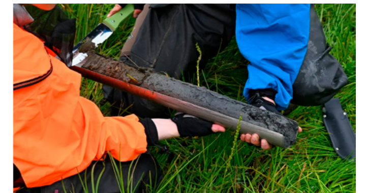
Figure 5 : Exemples de carottes de sols en zones humides, en bas dans un marais et à droite dans un pré salé en Amérique du Nord (Kirwan et al., 2021 et Peck et al., 2025)
